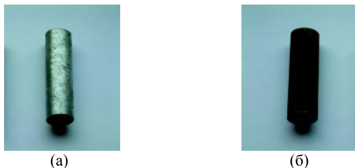
Рис.1. Фотографии отрезков заземляющего стержня с цинковым покрытием, нанесенным горячим способом, толщиной Zn - 0.08 мм (а) до и (б) после проведения испытания на коррозионную стойкость.
