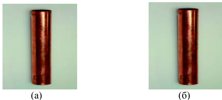
Рис. 2. Фотографии отрезков омедненного электролитическим способом заземляющего стержня с толщиной покрытия Cu - 0.250 мм (а) до и (б) после проведения испытания на коррозионную стойкость.
