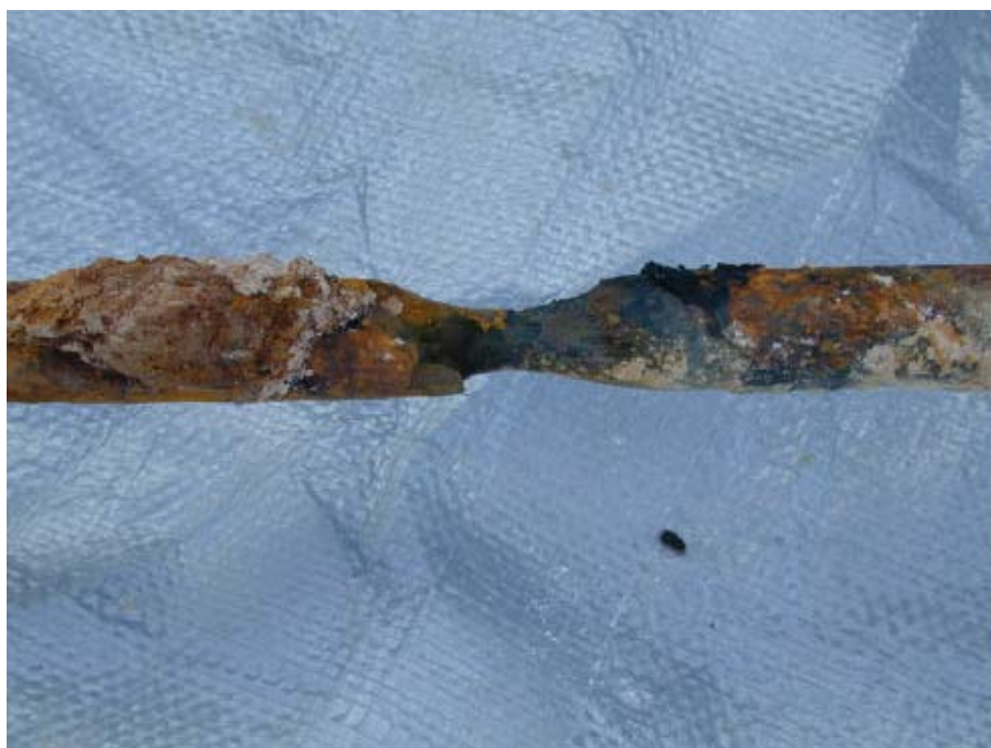
Рисунок 4. Электрод типа I, находящийся рядом с оцинкованным на 3/4 дюйма стержневым электродом длиной 3,04 м, извлеченный по прошествии 10 лет.
