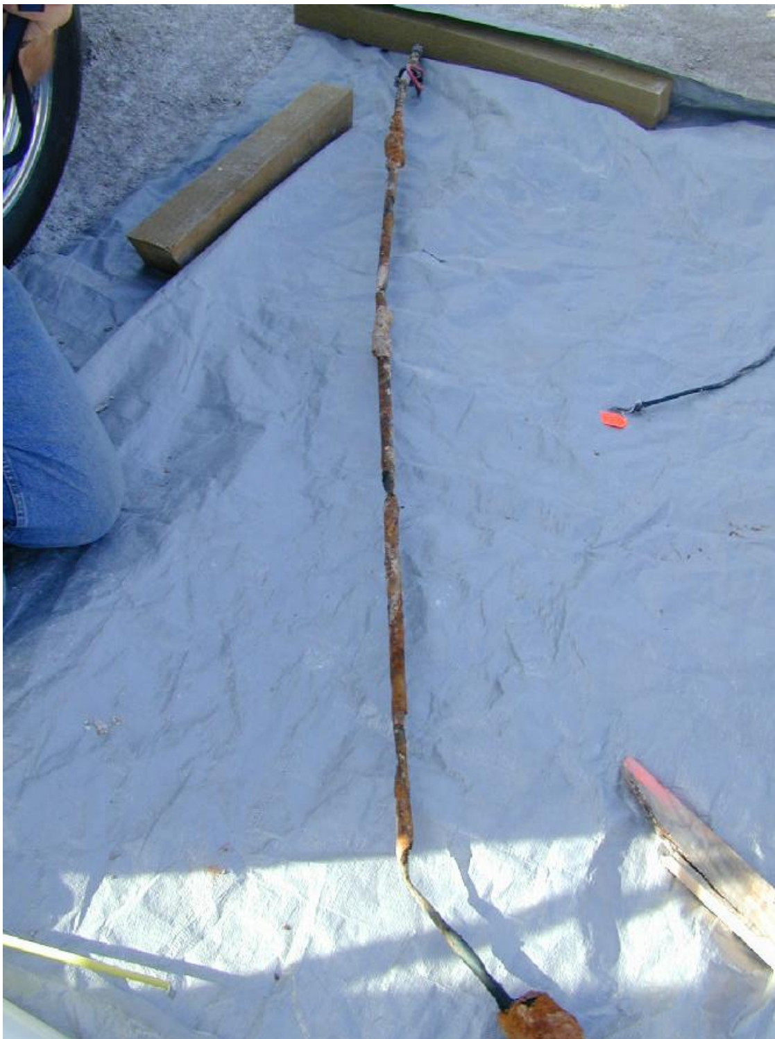
Рисунок 1. Оцинкованный на 3/4 дюйма стержневой электрод длиной 3,04 м, извлеченный по прошествии 10 лет (Производственный участок Павни)
