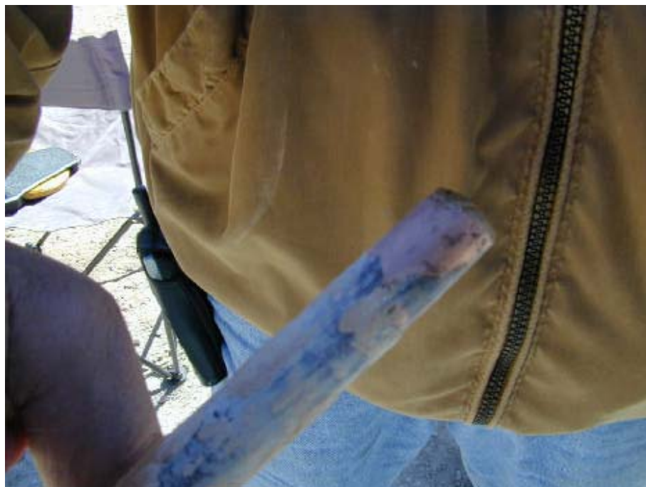
Рисунок 3. Электрод типа Н, находящийся рядом с покрытым медью на 5/8 дюйма стержневым электродом длиной 2,45 м, извлеченный по прошествии 10 лет
